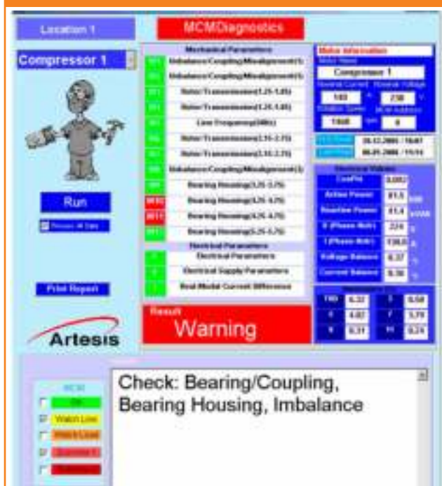
איור 2: דוגמה להתרעה של מערכת בקרה לניטור מנועים
