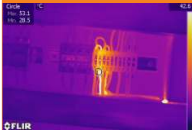
איור 4: דוגמה - זיהוי "נקודות חמות" בלוח חשמל באמצעות סריקה תרמוגרפית
